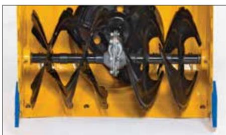
В машинах серии 2X для уборки снега применяется двухступенчатая система. На первом этапе несколько сегментов X-treme, расположенных строго под прямым углом к направлению движения, измельчают даже жесткий и плотно утрамбованный снег, затягивая его в шнековый загребной ковш. На втором этапе мощная высокоскоростная крыльчатка далеко выбрасывает снег через желоб.
