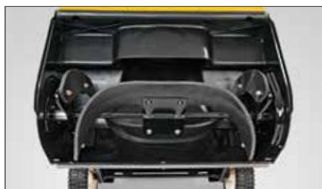
Отличительной особенностью серии 1X является прочный резиновый шнек, усиленный кордом. При работе такой резиновый шнек очищает дорожку до уровня земли. Благодаря эргономичным ручкам с дистанционным управлением желобом, фаре и электрическому стартеру этот небольшой агрегат обеспечивает высочайший уровень комфорта, несмотря на компактность.
